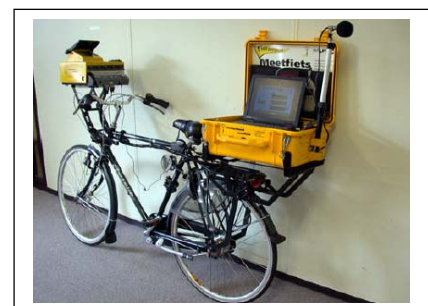
Figuur 3-2: de meetfiets van de fietsersbond
