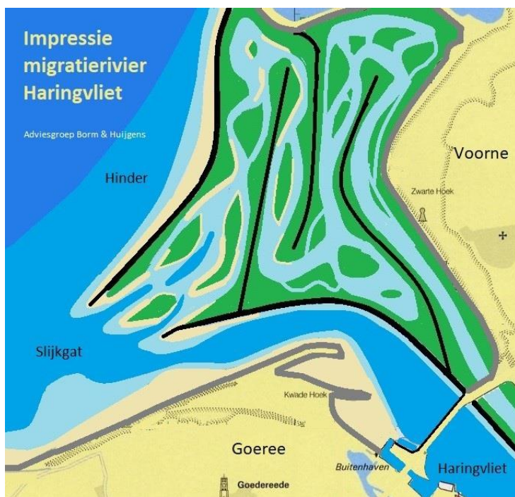
Figuur 3.14 Ontwerp voor een forse migratierivier met estuariene milieus van tientallen kilometers lengte tegen de kust gelegen op de Slikken van Voorne tussen de Maasvlakte en de monding van het Haringvliet. Deze 'gevouwen' variant kan worden uitgevoerd in uitgerechte vorm aan de zuidflank van de Maasvlaktes
