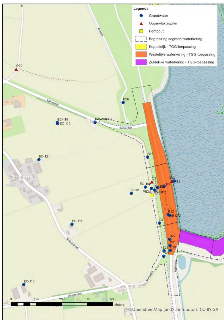
Figuur 2.2 meetpunten waterkwaliteit westelijke waterkering
