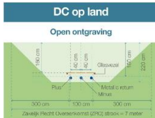
Figuur 2.8. Sleuf bij open ontgraving
