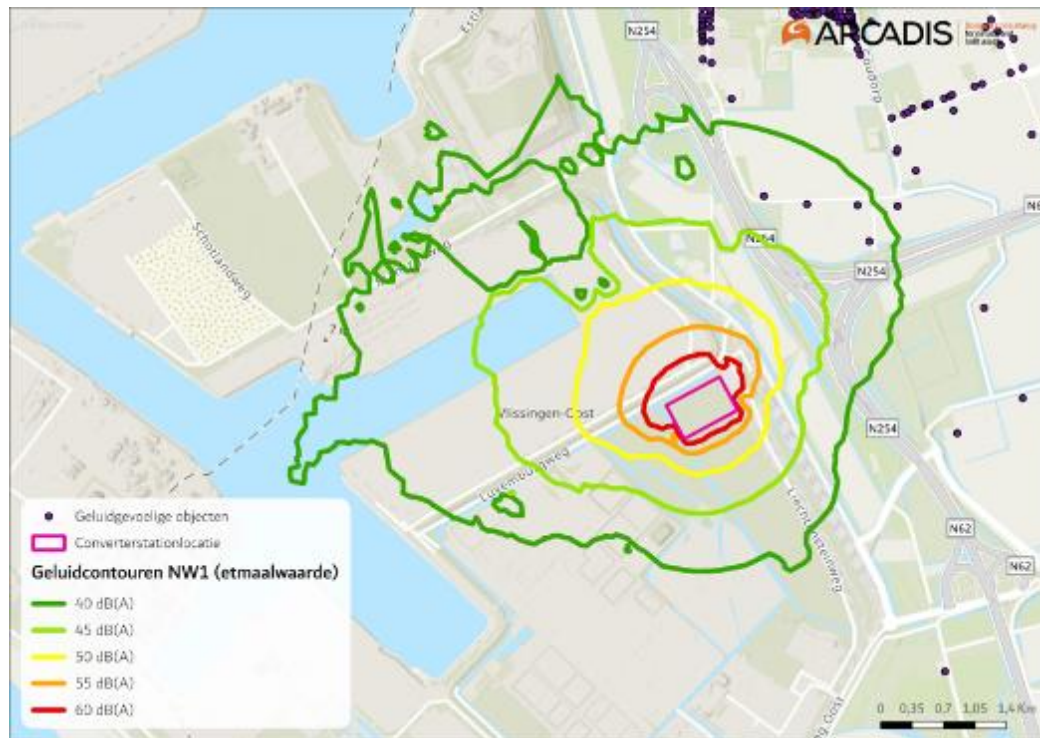
Figuur 5.12. Geluidcontouren converterstation Nederwiek 1 zonder maatregelen
