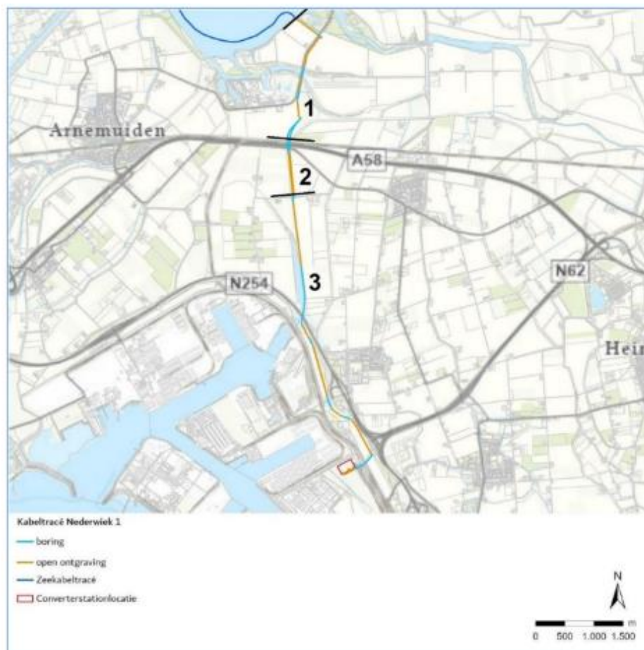
Figuur 5.6 deeltrajecten vanaf aanlanding tot converterstationlocatie
