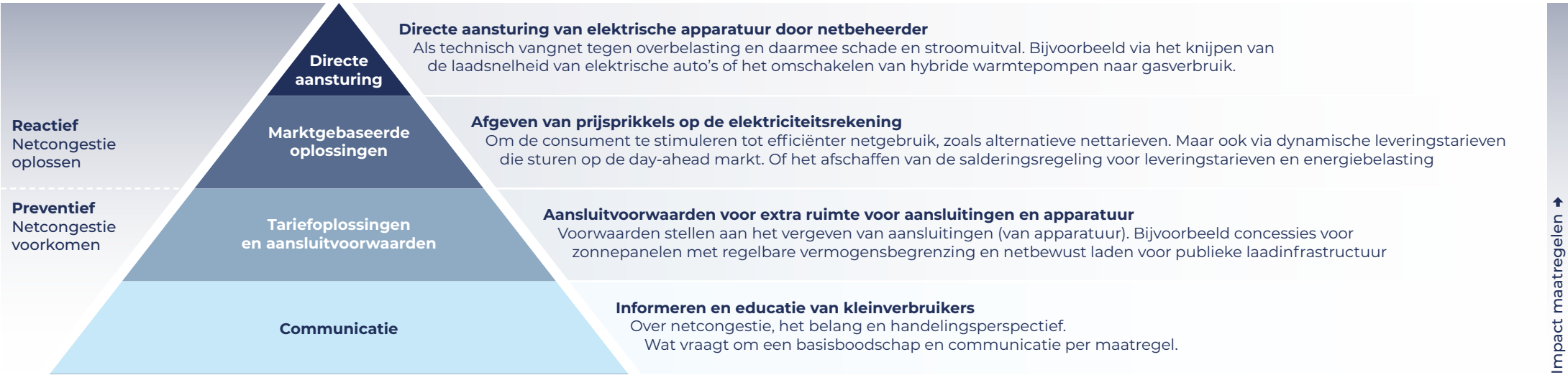
Figuur 16 Maatregelenladder voor het efficiënter benutten van het net, opgemaakt op basis van de Actieagenda netcongestie laagspanningsnetten. Hoger in de piramide worden maatregelen ingrijpende voor de consument.
