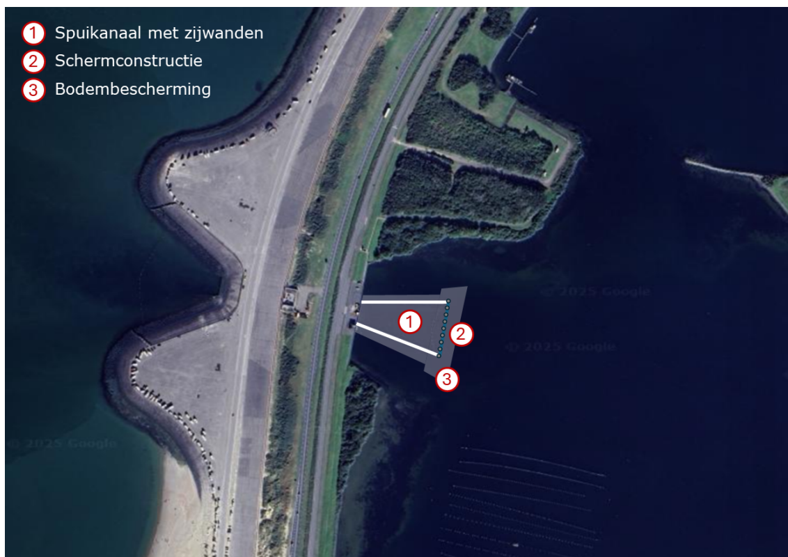
Figuur 10: Principeoplossing zoutdam bij Brouwerssluis.
