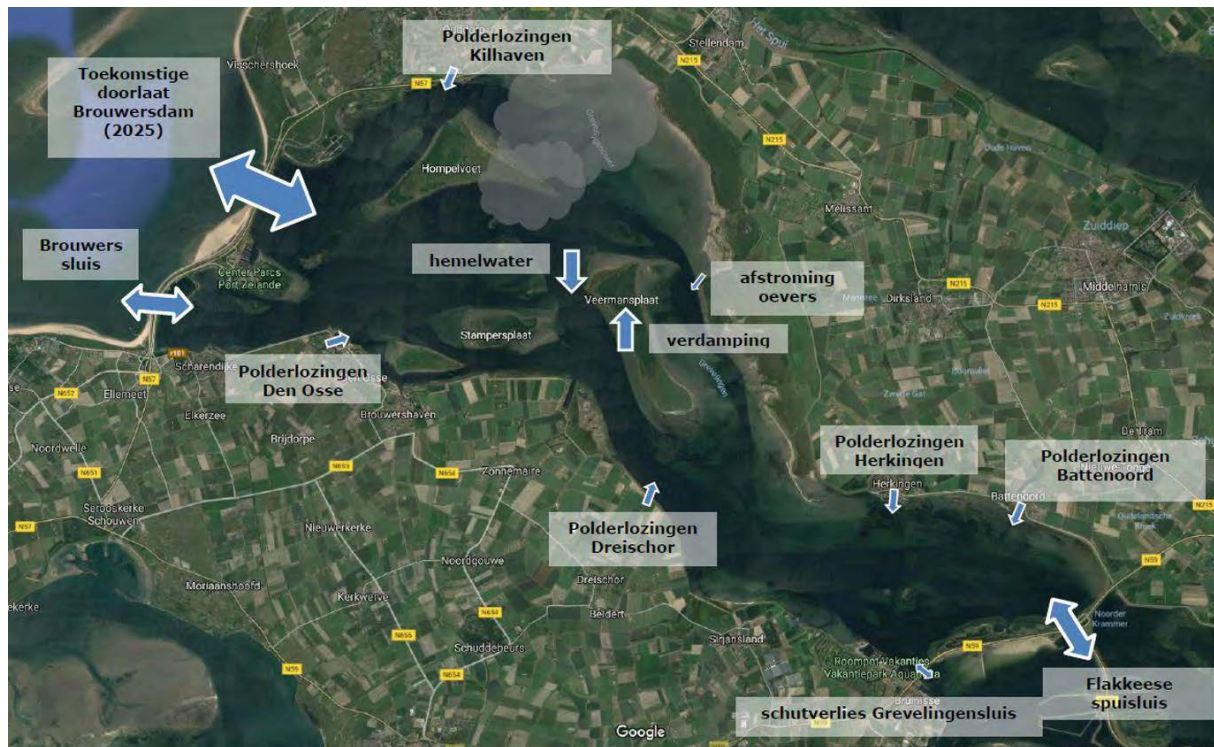
Figuur 8: Schematische representatie van de waterbalans voor de Grevelingen. Figuur afkomstig van https://www.deltaexpertise.nl/grevelingen/systeemrapportage/waterhuishouding.html .
