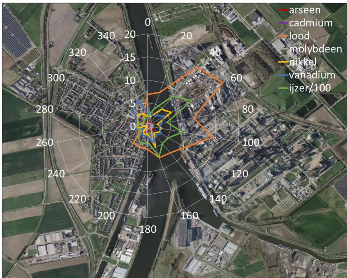
Figuur 4. Pollutieroos van arseen (rood), cadmium (paars), lood (oranje), molybdeen (grijs), nikkel (geel), vanadium (blauw) en ijzer (groen) voor meetstation Sluiskil. De as in de grafiek geeft de gemiddelde concentratie (ng/m 3 ) per windrichting van 20°.
