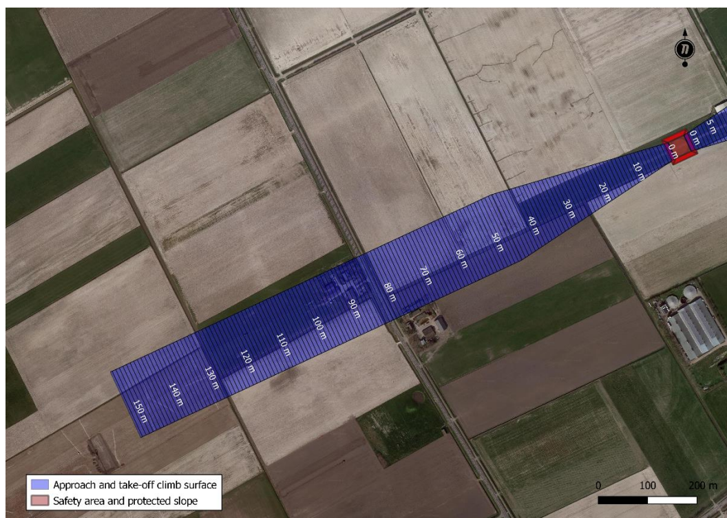
Figuur 7: Obstakelvrije vlak langs de westelijke aanvliegroute van de heliport
