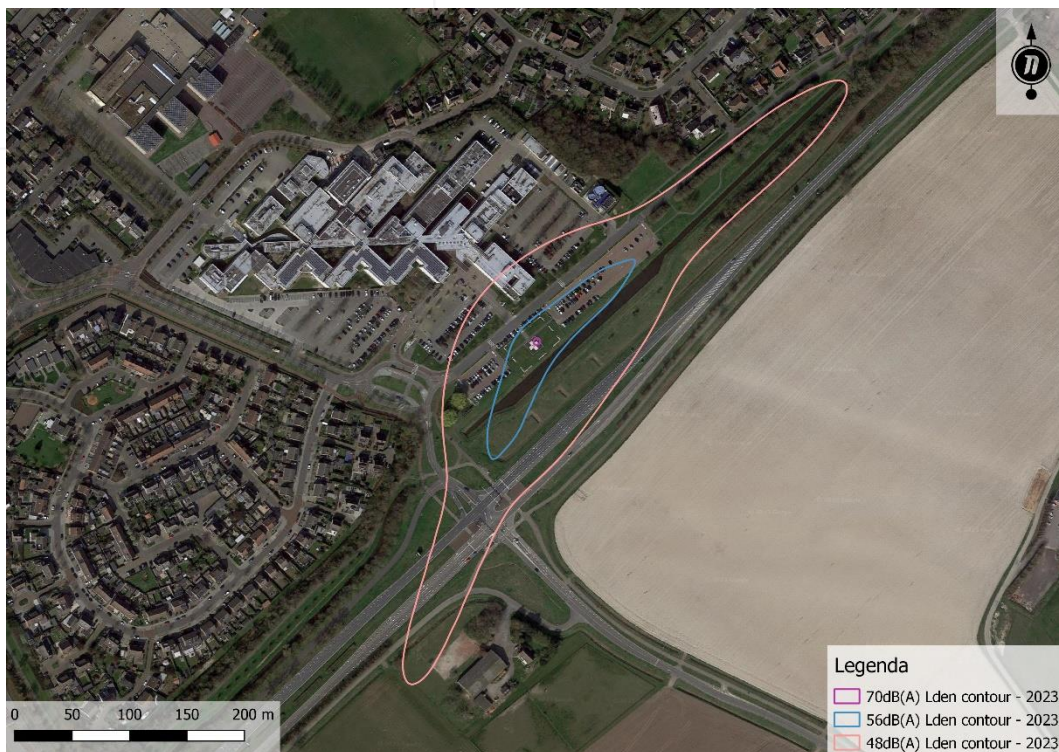
Figuur 1 Geluidbelasting ziekenhuis ZorgSaam actualisatie 2023
