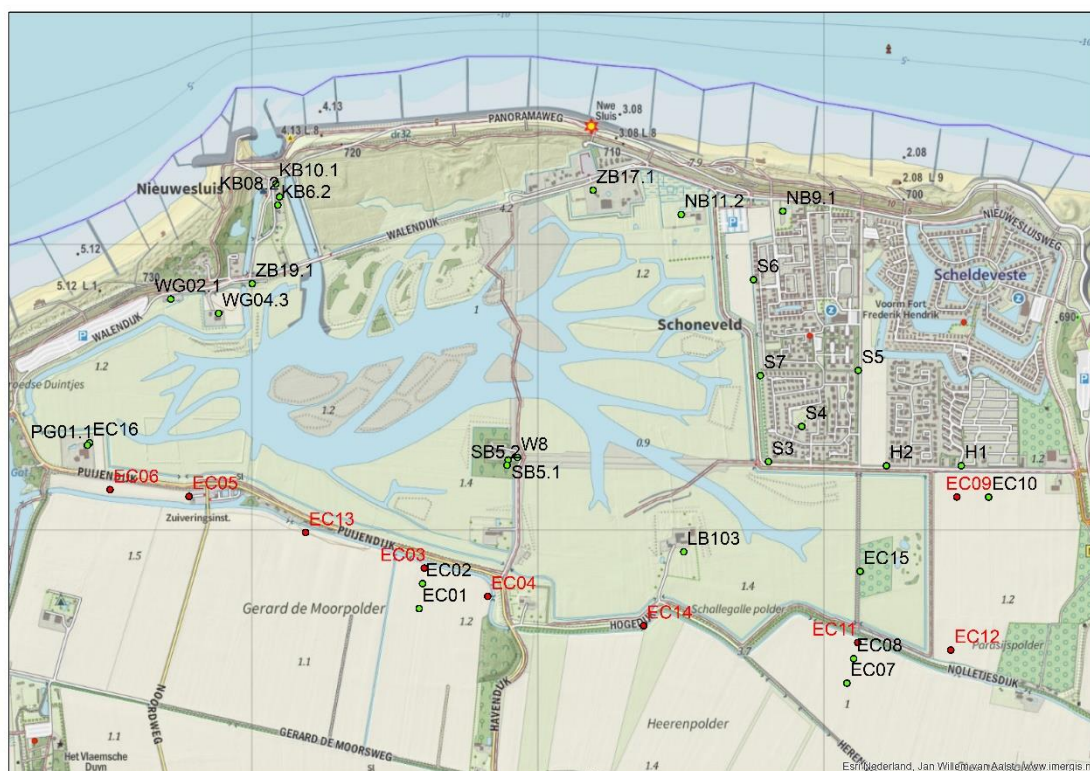
Figuur 1.5 Meetnet grondwatermetingen Waterdunen. In de rode meetpunten wordt naast de grondwaterstand (of stijghoogte) ook het zoet-zout grensvlak met de EM-SlimFlex gemeten.
