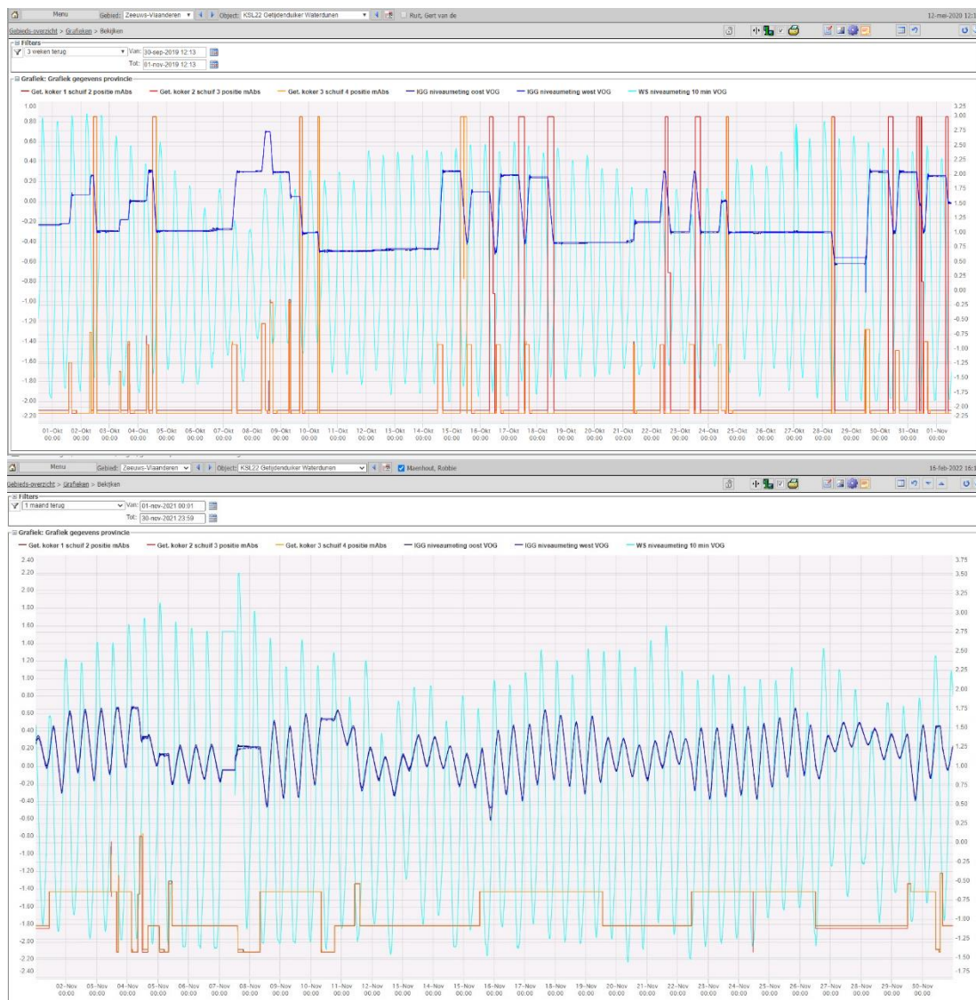
Figuur 2.3 De schuifstanden van de duiker (oranje), het waterpeil in Waterdunen (donkerblauw) en het Westerscheldepeil (lichtblauw) voor een maand in de testfase (oktober 2019, boven) en de operationele fase (november 2021, onder).
