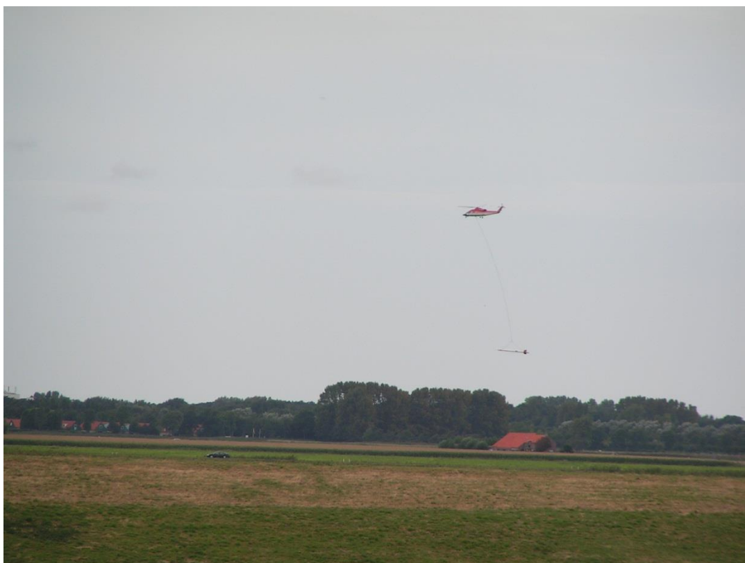
Figuur 2.8 Het uitvoeren van Elektromagnetische metingen vanuit een helikopter (BGR-systeem) voor het in kaart brengen van het zoutgehalte in de ondergrond van Zeeland: het FRESHEM-project.
