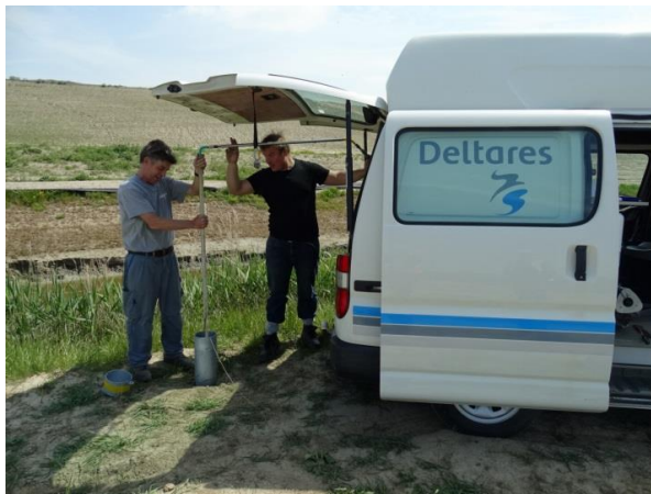
Figuur 2.11 Uitvoering van een EM-Slimflex-meting voor het in beeld brengen van de verdeling van het zoete, brakke en zoute grondwater
