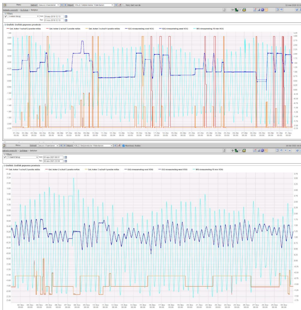
Figuur 3.3 De schuifstanden van de duiker (oranje en rood), het waterpeil in Waterdunen (twee donkerblauwe vrijwel overlappende lijnen in westelijk en oostelijk meetpunt, linker y-as) en het Westerscheldepeil (lichtblauw, rechter y-as) voor een maand in de testfase (oktober 2019, boven) en de operationele fase (november 2021, onder). Bron: Waterschap Scheldestromen.
