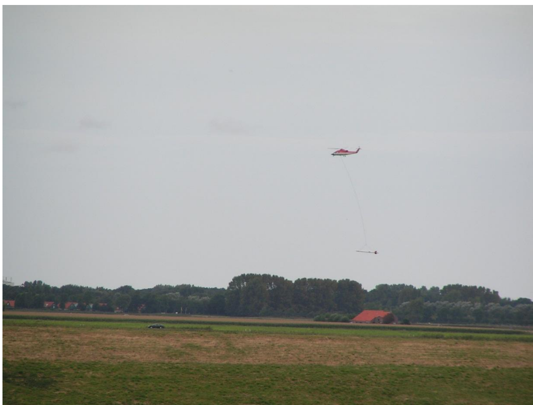
Figuur 3.20 Het uitvoeren van Elektromagnetische metingen vanuit een helikopter (BGR-systeem) voor het in kaart brengen van het zoutgehalte in de ondergrond van Zeeland: het FRESHEM-project.
