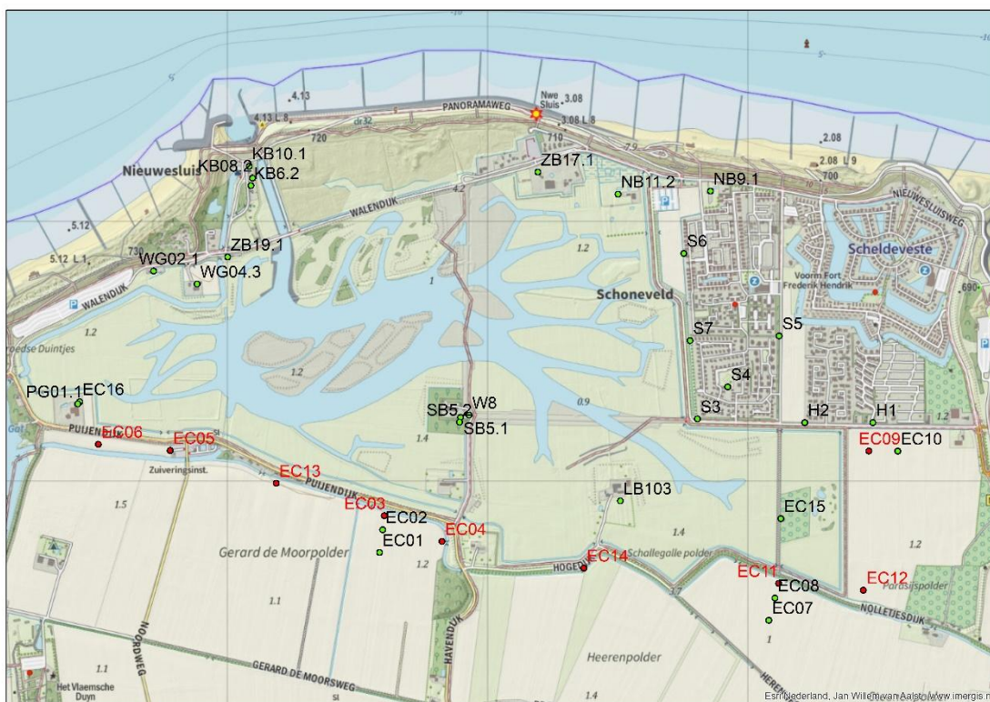
Figuur 2.1 Meetnet grondwatermetingen Waterdunen. In de rode meetpunten wordt naast de grondwaterstand (of stijghoogte) ook het zoet-zout grensvlak met de EM-SlimFlex gemeten.
