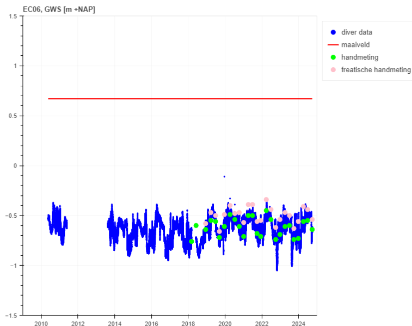
Figuur 3.12 Stijghoogtemeting op locatie EC06. Blauw: continu (met diver) gemeten stijghoogte. Groene cirkel: handmetingen in dezelfde peilbuis als de diver. Roze cirkel: handmetingen van freatische grondwaterstand in de ondiepe peilbuis
