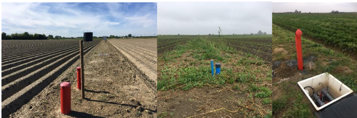
Figuur 2-16: Links: Waarnemingsput PB1 (voorste rode buis: PB1.1-1.3, achterste rode buis: PB1.4) met daarnaast de neerslagmeter (zwart). Midden: Waarnemingsput PB2 (linker blauwe buis: PB2.1, rechter blauwe buis: PB2.2). Waarnemingsput PB3 is vergelijkbaar met PB2. Rechts: Waarnemingsputten rondom IP1, met IP1.1 en IP1.2 in de bronkist en IP1.3 in de rode buis die daarnaast is geplaatst. Waarnemingsputten rondom IP2 en IP3 zijn vergelijkbaar met die rondom IP1.
