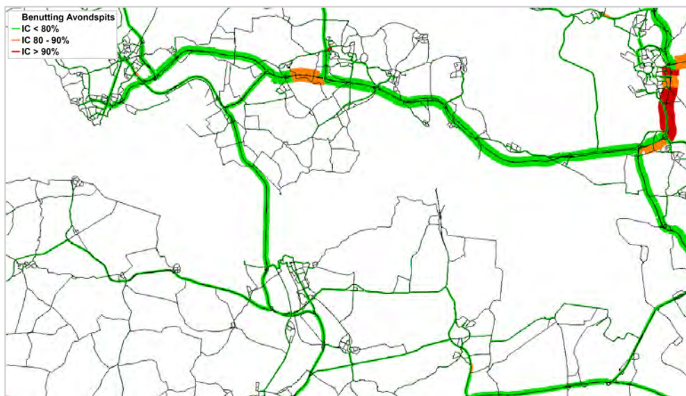
Figuur 5.23: Benutting in de avondspits Alternatief 2030 tolvrij personenauto en 80 km/uur scenario Hoog
