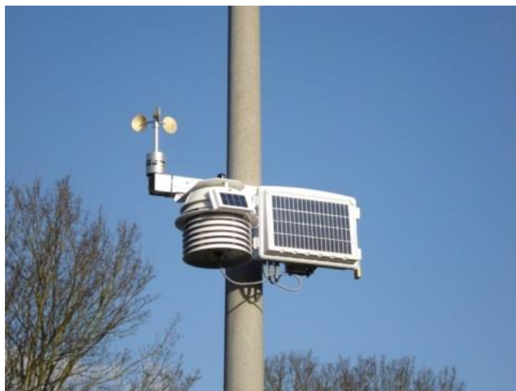
Figuur 2. Impressie van meetstation in gebouwd gebied. De metingen vinden plaats op een hoogte van ongeveer 3.5 m. Uit de metingen van luchttemperatuur, luchtvochtigheid, windsnelheid en intensiteit van de zonnestraling wordt de UTCI berekend.
