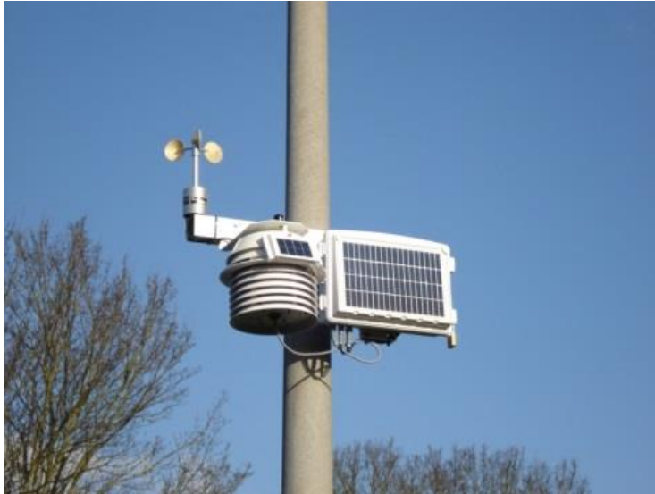
Figuur 3. Impressie van meetstation in gebouwd gebied. De metingen vinden plaats op een hoogte van ongeveer 3.5 m. Uit de metingen van luchttemperatuur, luchtvochtigheid, windsnelheid en intensiteit van de zonnestraling wordt de UTCI berekend.
