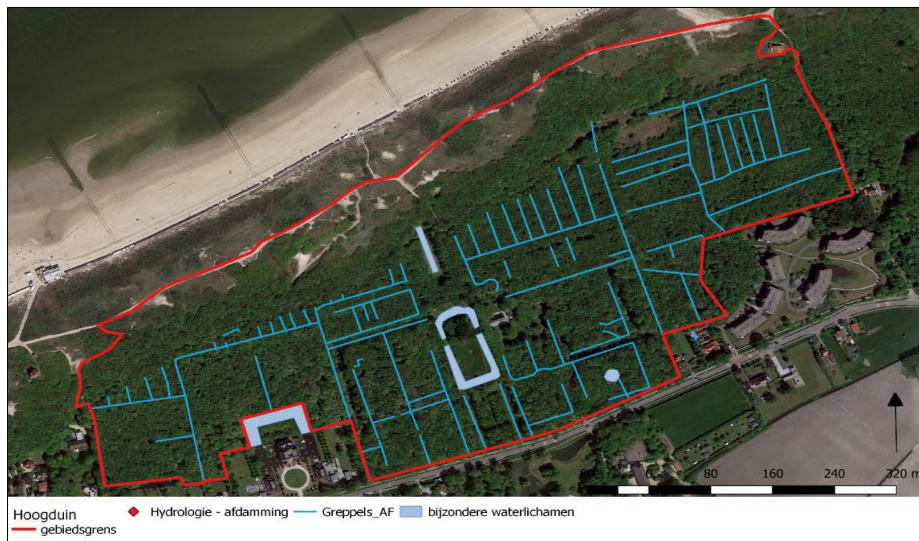
Figuur 20. Ont- en afwateringsstelsel op Buitenplaats Hoogduin (Leunisse et al, 2020).
