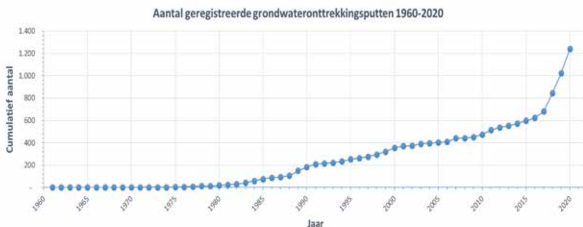
Figuur 7. Ontwikkeling aantal geregistreerde diepdrains in Zeeland
