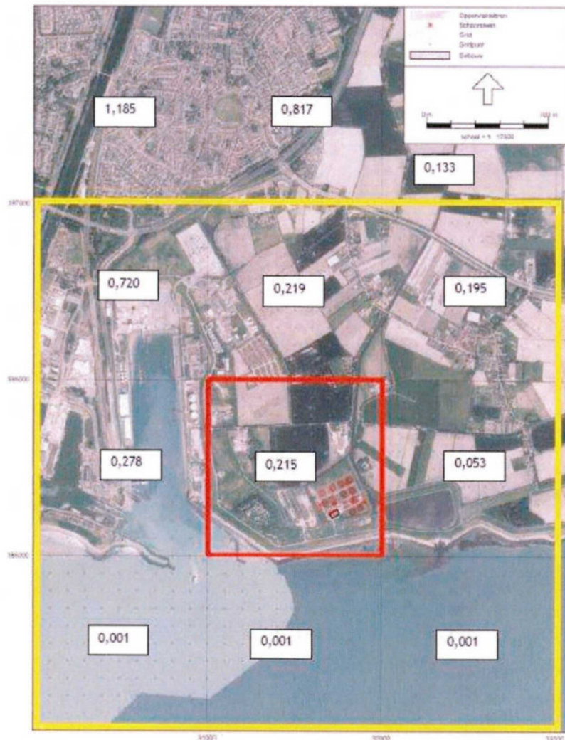
Figuur 6: Het onderzoeksgebied en de ruwheidslengte per vierkante kilometer volgens de PreSRM. Het doelgebied (rood omkaderd) heeft een ruwheidslengte van 0,215 m
