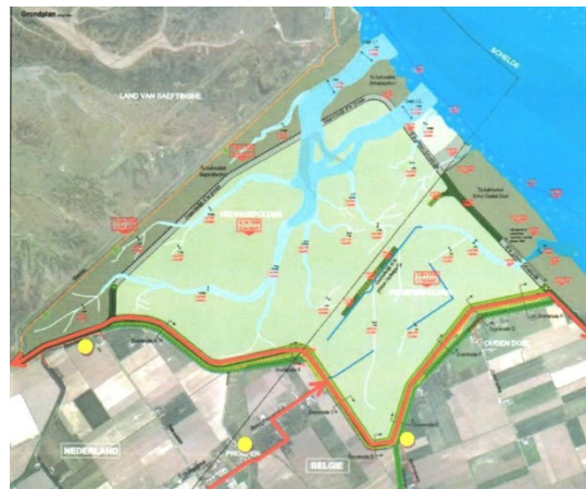
Het r.i.p. met gegraven zwinen van 4 meter diep.
