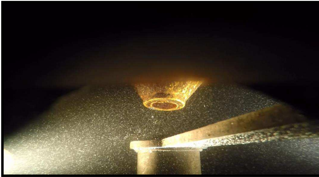
Figuur 3: de waterQi produceert zeer kleine zuurstofbelletjes
