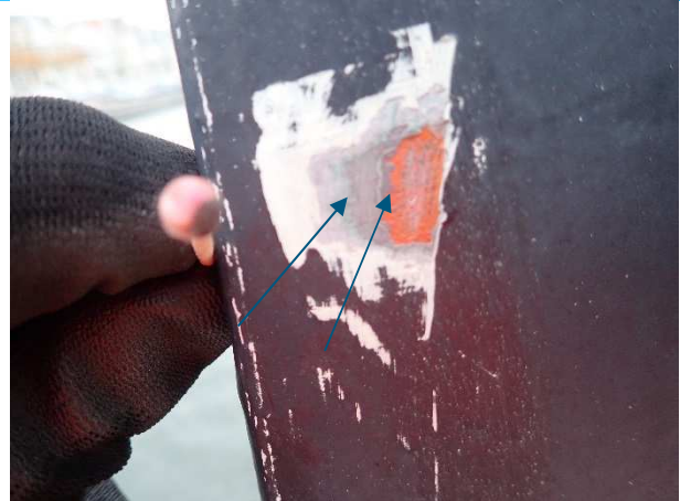
Foto 2: test op Chromo VI op hanger, staafje is (op foto moeilijk te zien) verkleurd als gevolg van aanwezigheid chromo VI, waarschijnlijk in de groene lagen (zie pijlen), oranje is overduidelijk loodmenie
