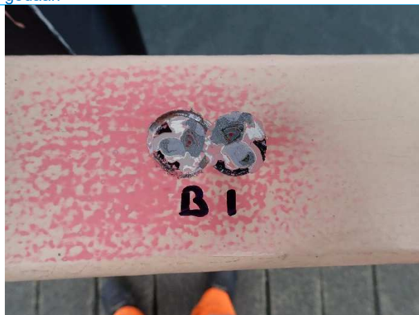
Foto 5: meetresultaat pull off test op leuning Zuidzijde. Waarde 4,51 MPa, gecompliceerd breukvlak a.g.v hoeveelheid lagen en onderlinge hechting
