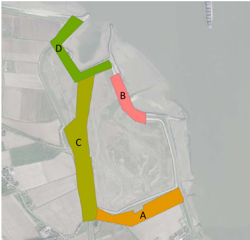
Figuur 1.1 Dijkvakken waarin TGG is toegepast liggen in de deelgebieden A, C en D. Deelgebied B betreft de voormalige zeedijk, die bij de ontpoldering is verwijderd
