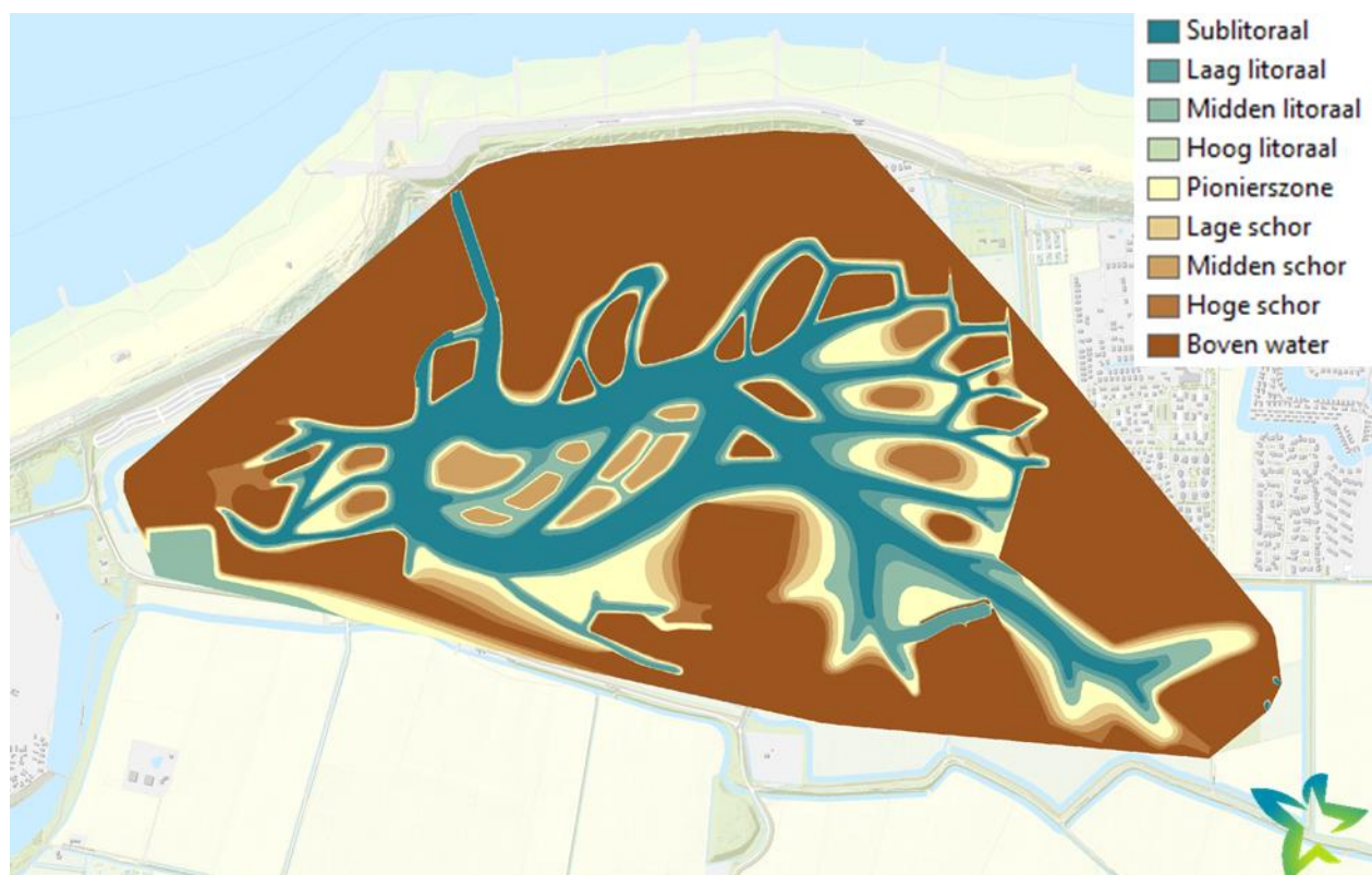
Figuur 7-15: Verdeling van ecotopen bij nieuwe operatie. De estuariene ecotopen zijn verdeeld op basis van de droogvalduur (%) en overstromingsfrequentie (x/jaar), zoals gedefinieerd in het Zoute wateren Ecotopen Stelsel (ZES.1) en de huidige hoogteligging (zoals aangegeven in de ontwerptekeningen) en gesimuleerde getijdenwerking bij nieuwe operatie (incl. maatregelen, springtij van +0,75 NAP) van Waterdunen.
