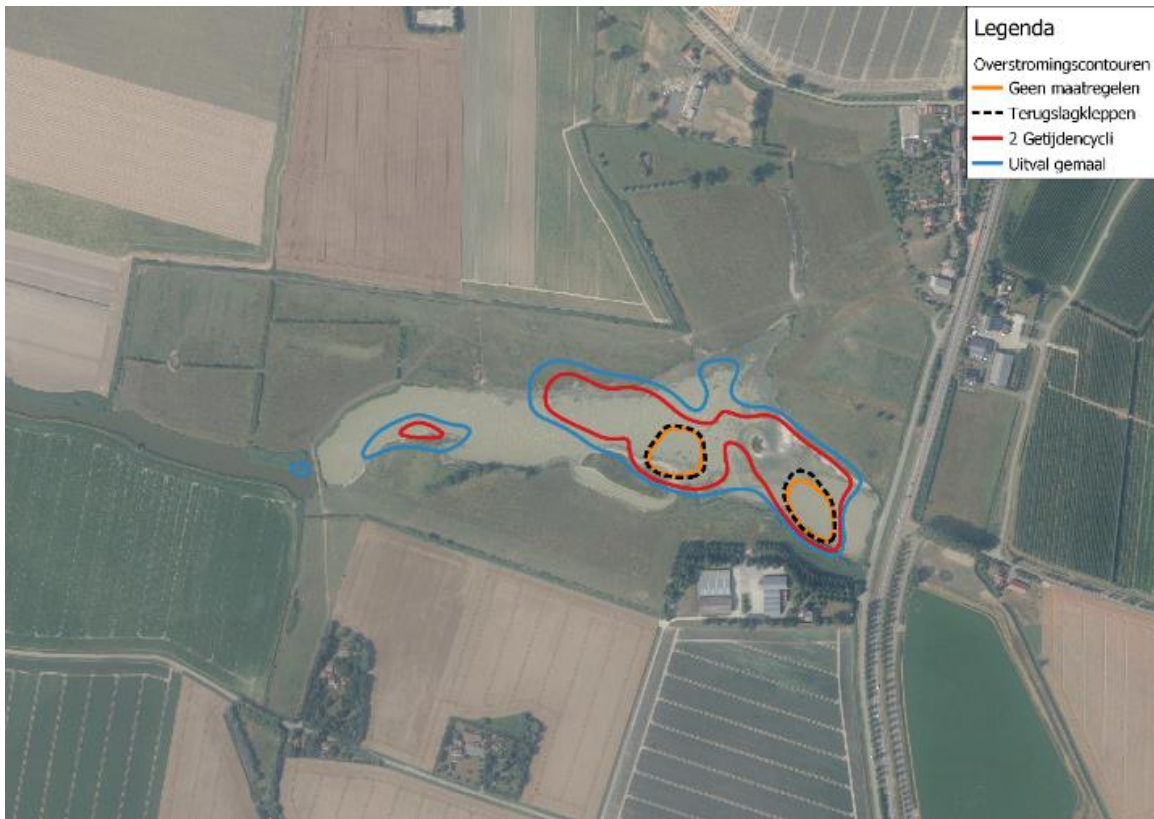
Figuur 8-10. Overstromingscontouren van de verschillende scenario's ter plaatse van de Baarzandse creek
