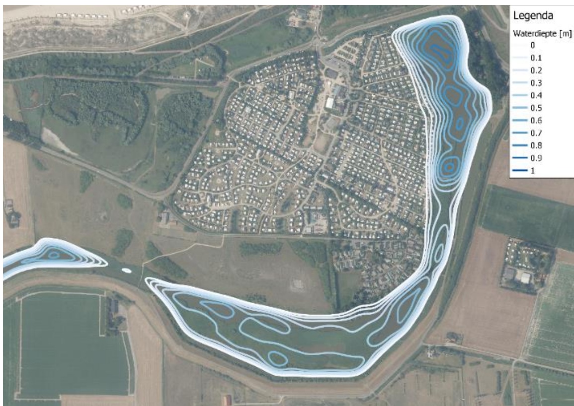
Figuur 8-13. Contouren van de waterdiepten als gevolg van water afkomstig uit Waterdunen voor het scenario: Terugslagkleppen
