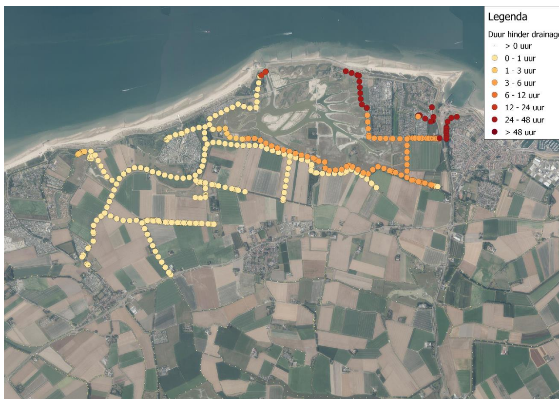
Figuur 8-16. Locaties met potentiële hinder voor drainage met tijdsindicatie voor een situatie zonder maatregelen
