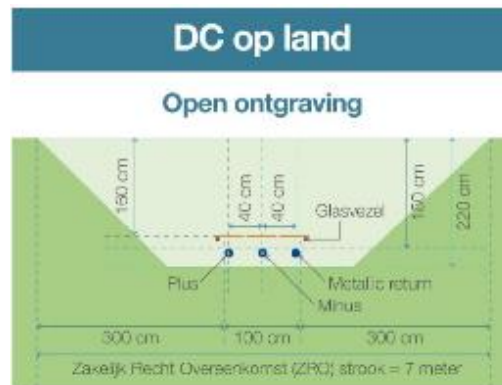
Figuur 2.8. Sleuf bij open ontgraving
