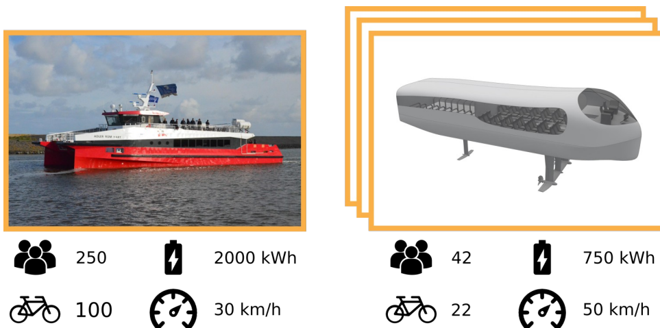
Figuur 5.2: Overzicht van de schepen in de nieuwe vloot en hun eigenschappen.
