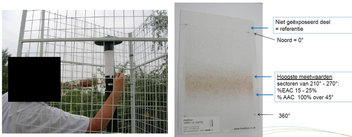
Figuur 4.1. De DustScan (links) met een bemonsterde plakstrip (rechts).
