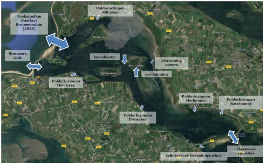
Figuur 6.2: Brouwerssluis, toekomstig doorlaatmiddel Brouwersdam, Flakkeese spuisluis en andere vormen van watertoevoer en –afvoer
