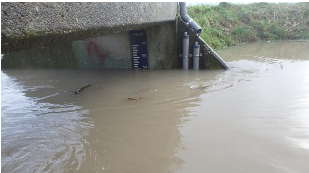
Opp-meetpunt waar het peil en zoutgehalte wordt gemeten, op 15 januari 2016
