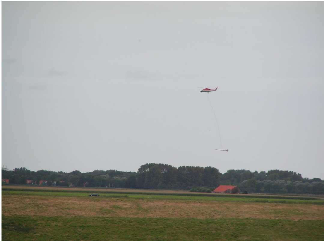
Figuur 3.3 Het uitvoeren van Elektromagnetische metingen vanuit een helikopter (BGR-systeem) voor het in kaart brengen van het zoutgehalte in de ondergrond van Zeeland: het FRESHEM-project.
