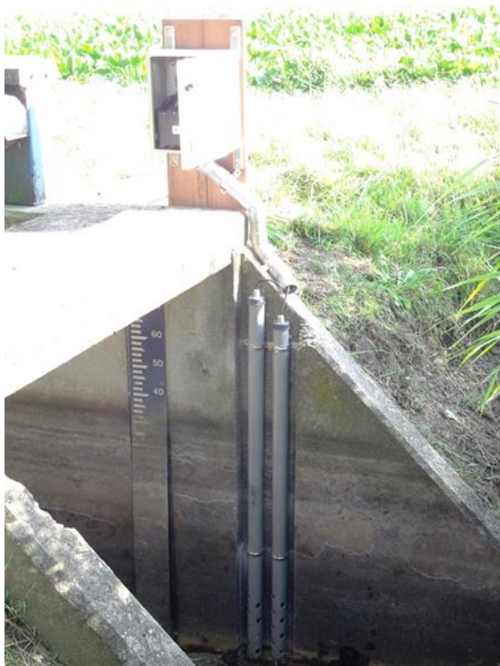
Het oppervlaktewater meetpunt Opp1 bij stuw Mariastraat Sensoren en telemetriesysteem in peilbuiskoker
