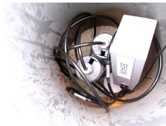
Het oppervlaktewater meetpunt Opp1 bij stuw Mariastraat Sensoren en telemetriesysteem in peilbuiskoker
