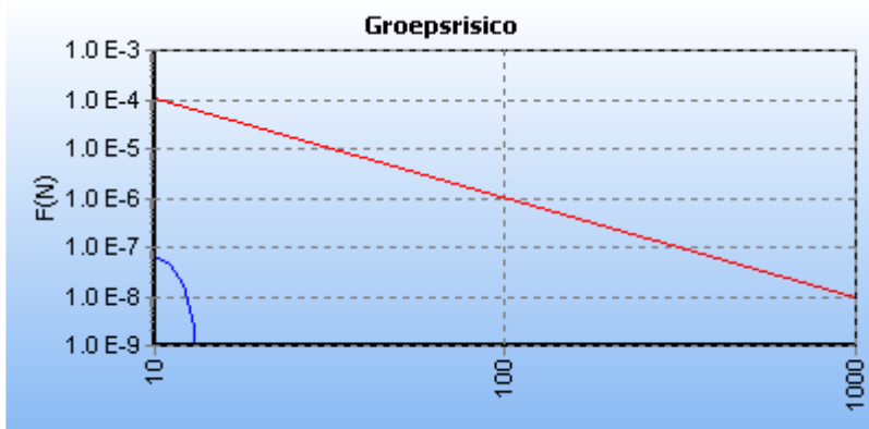
5.6 Figuur 5.6 FN curve voor A-667 van N.V. Nederlandse Gasunie voor de kilometer tussen stationing 79460.00 en stationing 80460.00
