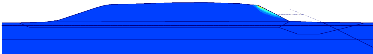
Figuur 5-25: Glijvlak leidingendam bij Laagwater
