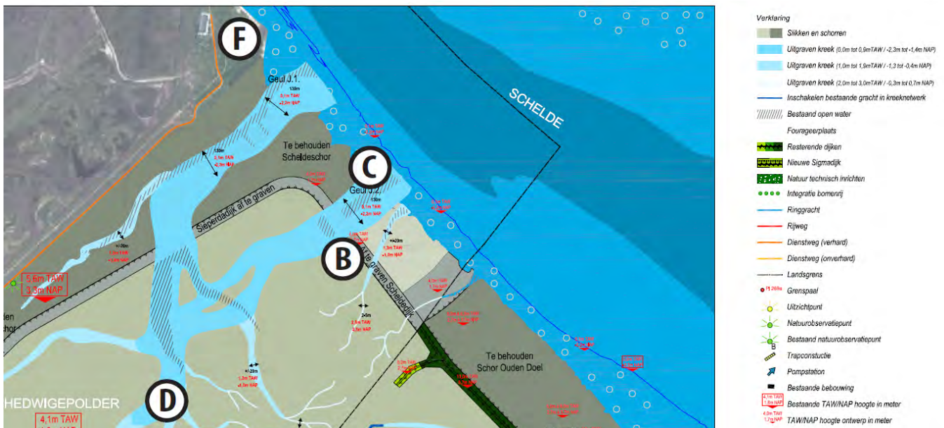
Figuur 2.1: Inrichtingsplan met ligging van de geplande geulen, kreek en schorvergraving (bron: ontwerp-rijksinpassingsplan, bijlage 5)
