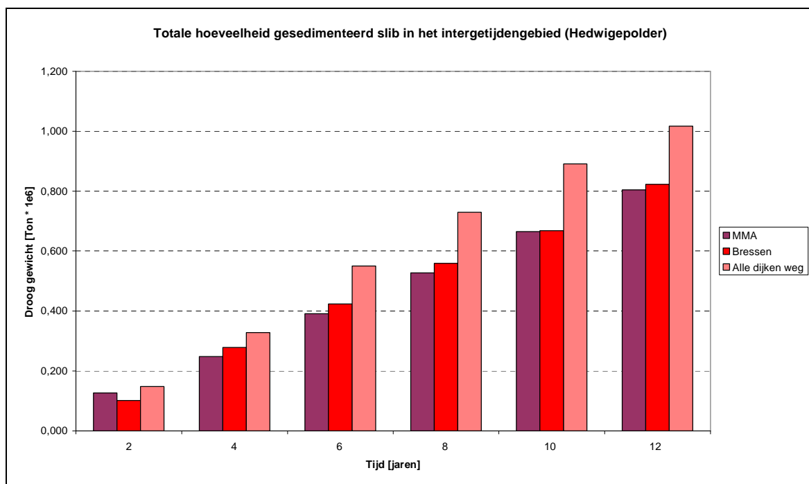
Figuur 3-3: Gemodelleerde totale hoeveelheid gesedimenteerd slib in de Hedwigepolder in basisalternatieven 1B (bressen) en 3 (progressief dijken weg-alternatief) en in het MMA.
