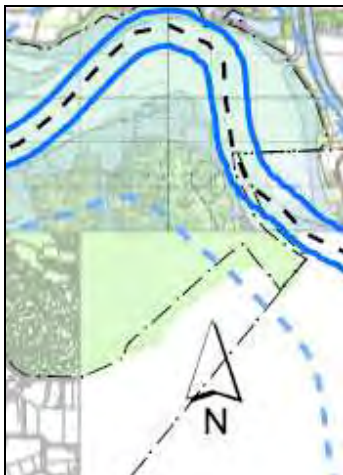
Figuur 6.82: Geluidscontouren tengevolge van scheepvaartverkeer op de Schelde in de huidige situatie (2002). Volle blauwe lijn = 50dB(A)-contour, stippellijn = 40dB(A)-contour. Bron: SMER OS2010 - aspect geluid - thema toegankelijkheid, Geluidscontouren Huidige Situatie 2002).
