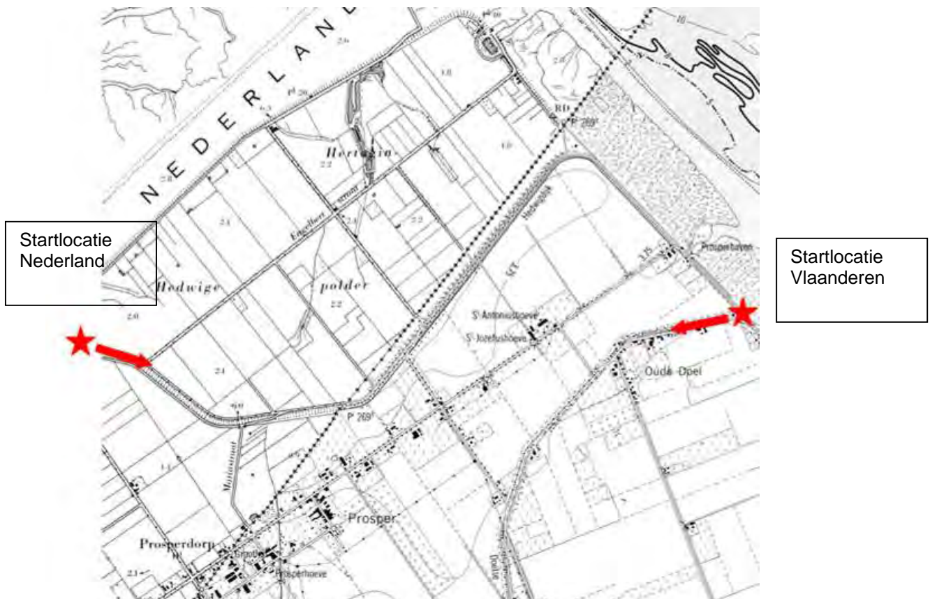
Figuur 3.23: Startlocaties voor de aanleg van de nieuwe waterkerende dijk (1/25.000). Langs Vlaamse zijde is men inmiddels gestart met de werken voor de aanleg van de ringdijk.
